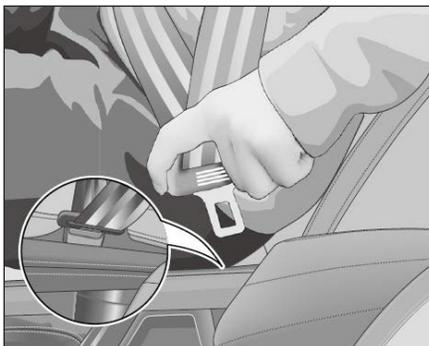
È possibile sbloccare la cintura di sicurezza premendo il pulsante rosso sulla fibbia. Dopo aver sbloccato la cintura di sicurezza, spingerla verso il punto di fissaggio superiore e la cintura di sicurezza verrà riavvolta automaticamente nell'arrotolatore.
