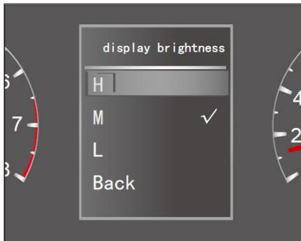
Dopo essere entrati nell'interfaccia di impostazione della luminosità del display, premere il pulsante INFO per selezionare "high", "medium", "low" e "return" ("alta", "media", "bassa" e "indietro"). Premere il tasto RESET per selezionare.
