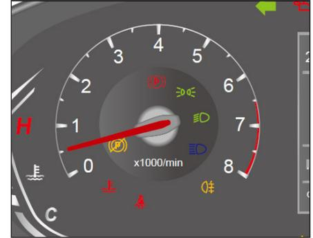
Il tachimetro indica la velocità di rotazione del motore e il prodotto del valore indicato dalla lancetta per 1000 giri/min è la velocità del motore.
