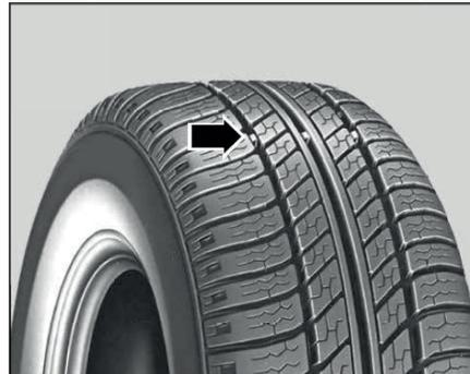
Sostituire lo pneumatico quando sugli pneumatici originali sono presenti segni di usura nelle scanalature del battistrada e distribuite sulla circonferenza degli pneumatici. Quando il disegno del battistrada si consuma fino all'indicatore, sarà necessario sostituire lo pneumatico.
