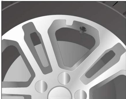
1. Rimuovere il tappo della valvola dello pneumatico e controllare che la valvola non presenti perdite con il metodo del sapone.
