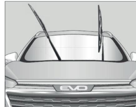
1. Sollevare completamente il braccio del tergicristallo dal parabrezza. Collocare un asciugamano spesso nella parte inferiore del braccio del tergicristallo per evitare di danneggiare il parabrezza a causa del rimbalzo accidentale del braccio.
