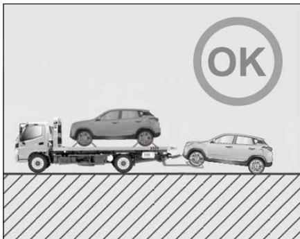
Rilasciare il freno di stazionamento elettronico, sollevare e fissare le ruote anteriori.
