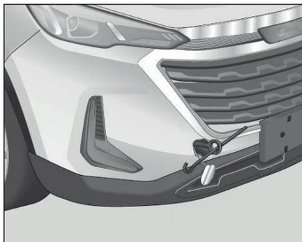
4. Serrare saldamente l'anello di traino con la chiave da ruote.
