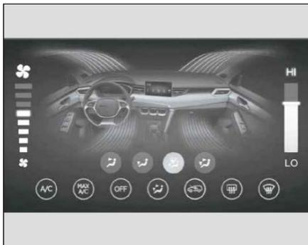
Visualizzazione quando si entra nell'interfaccia di climatizzazione del sistema di navigazione AV.
