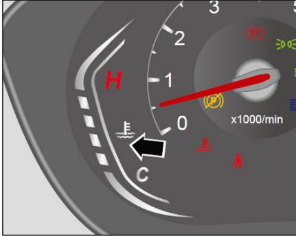
L'indicatore della temperatura del refrigerante motore viene utilizzato per indicare la temperatura del liquido di raffreddamento nel motore.
