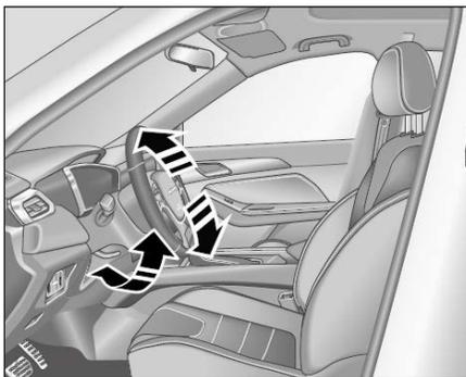
Rilasciare la leva di bloccaggio di regolazione del volante, regolare la posizione del volante verso l'alto e verso il basso, garantendo così il comfort e la sicurezza di persone di diverse stature.
