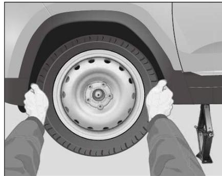
1. Allineare i fori di installazione sulla ruota di scorta con i fori di installazione sul disco del freno, quindi posizionarli sul mozzo.
