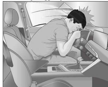
Anche se la velocità del veicolo è molto bassa, in caso di collisione frontale la forza applicata al corpo umano sarà molto elevata e sarà impossibile per un passeggero sostenere il proprio corpo con le mani. Di conseguenza, il passeggero che non allaccia la cintura di sicurezza viene sbalzato in avanti e urta violentemente contro il volante, il cruscotto, il parabrezza anteriore o altri oggetti.
