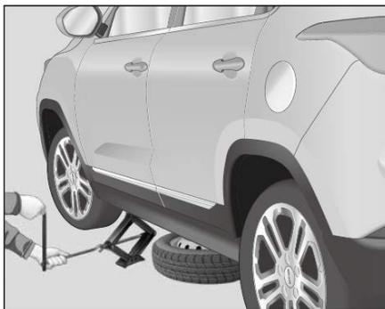
7. Ruotare in senso orario il cric e sollevarlo con le apposite leve e rimuovere la ruota da sostituire quando si solleva da terra.
