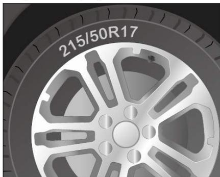
Controllare l'etichetta del veicolo per identificare i modelli e le dimensioni degli pneumatici.
