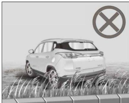
Non parcheggiare il veicolo su materiali infiammabili come foglie secche o fieno, altrimenti il motore ad alta temperatura o il tubo di scarico potrebbero incendiare tali materiali infiammabili e causare un incendio.
