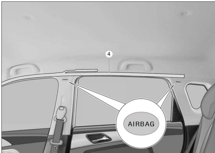
Gli airbag laterali a tendina -4- sono situati nella trave longitudinale su entrambi i lati del tetto del veicolo. Il montante B e il montante C sono contrassegnati dalla dicitura "AIRBAG".
