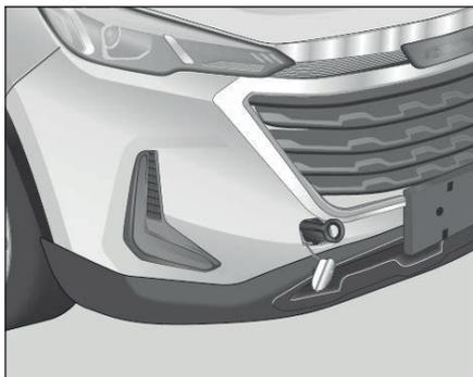
3. Avvitare completamente l'anello di traino in senso orario nel foro.
