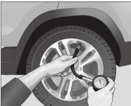
2. Posizionare saldamente il manometro di misurazione della pressione contro la valvola.
