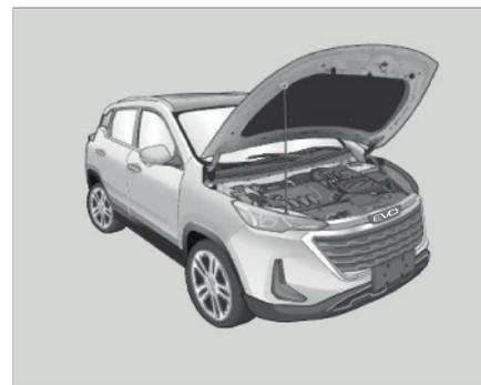
3. Aprire il cofano del motore all'altezza desiderata, tenere la guarnizione in gomma dell'asta di supporto, estrarre l'asta di supporto dalla fibbia e inserirne l'estremità nel foro ovale della carrozzeria per ottenere un adeguato sostegno.
