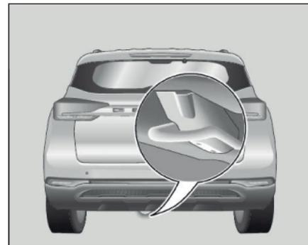
L'anello di traino posteriore è stato saldato direttamente al centro del veicolo.
