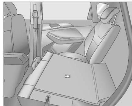
Tirare il pulsante di blocco esterno dello schienale sinistro e ruotare lo schienale in avanti ripiegandolo in due.
