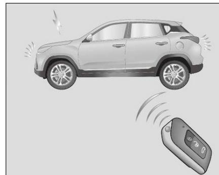
Quando il veicolo è in stato di chiusura con antifurto attivo e si trova a una distanza di < 15 m (campo aperto), premere due volte il tasto di blocco sulla chiave per 0,5 secondi per attivare la funzione di ricerca del veicolo. A questo punto, lo sterzo si attiva per due volte, il clacson suona due volte e la luce di posizione si accende per 8 secondi.
