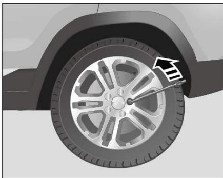
6. Svitare in senso antiorario il dado fisso della ruota difettosa con una chiave da ruota di 1 o 2 giri.
