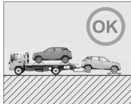
Rilasciare il freno di stazionamento elettronico, sollevare e fissare le ruote posteriori dopodiché fissare le ruote anteriori a pattini di piccole dimensioni.
