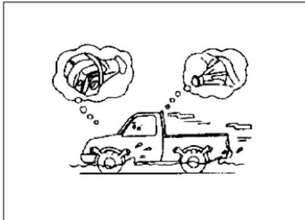
10. Fare attenzione a non far entrare l'acqua nel tubo del motore quando si guida attraverso fiumi poco profondi o pozzanghere, con conseguenti gravi danni al motore. Dopo aver superato l'acqua, controllate che gli oli degli ingranaggi degli assi anteriore e posteriore e del cambio non siano pieni d'acqua. Se si trova acqua mista a olio, scaricarla dopo aver riempito le scorte dell'olio per ingranaggi.
