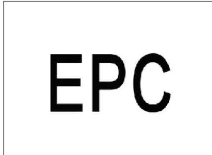
Quando l'interruttore di accensione viene ruotato in posizione "ON" la spia si accende per 2 secondi e poi si spegne. Se in posizione ON, l'indicatore non si spegne dopo 2 secondi, lo spegnimento deve essere forzato e potrebbe essere generato un codice di errore nello storico.
