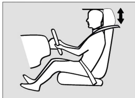
L'altezza dei poggiatesta deve essere regolata in base all'altezza dell'occupante e alla posizione della testa. Poggiatesta e cinture di sicurezza, quando regolati correttamente, forniscono una protezione efficace per gli occupanti.
