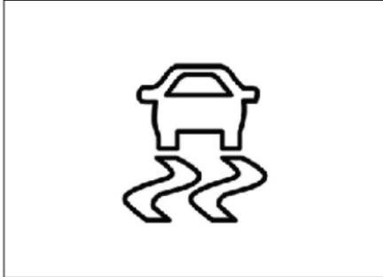
La spia ESC si accende quando l'interruttore di accensione viene portato su ON e si spegne dopo circa 3 secondi. Quando l'ESC si avvia, controlla lo stato di guida e, in condizioni di guida normale, l'indicatore ESC rimane spento. Durante la guida, se l'indicatore ESC lampeggia, si rischia la perdita di controllo del veicolo e la possibile perdita di trazione.
