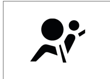
Sul cruscotto (sulla destra) è presente una spia con il simbolo dell'airbag. Quando il veicolo viene acceso, il sistema controlla il sistema airbag per escludere eventuali guasti e usa la spia per segnalare eventuali guasti elettrici. I controlli del sistema includono i sensori dell'airbag, i moduli airbag, il cablaggio e i moduli diagnostici. Quando il veicolo viene avviato, la spia si accende per sette secondi e poi si spegne. Questo significa che il sistema airbag è pronto.
