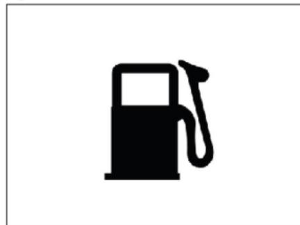
Si accende quando il livello di carburante è molto basso; il serbatoio deve essere immediatamente rifornito. Quando il livello del carburante si trova nella posizione "E", continuare a guidare il veicolo provocherà lo spegnimento del motore e danni al convertitore catalitico.
