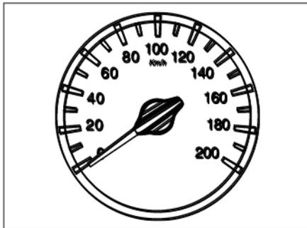
Il tachimetro visualizza la velocità di guida del veicolo in km all'ora (km/h). Durante il rodaggio del veicolo, prestare attenzione alle avvertenze indicate nella sezione "Istruzioni per la guida".
