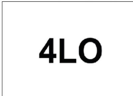
Quando il veicolo è in modalità di trazione integrale a bassa velocità, la spia è accesa.
