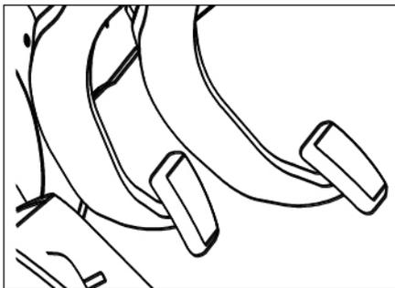
1. Controllare che il pedale funzioni regolarmente e assicurarsi di poterlo spingere più a fondo una volta premuto completamente.
