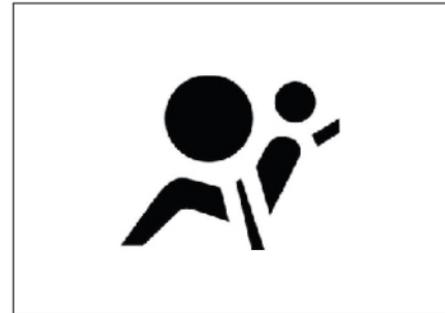
Quando l'interruttore di accensione del veicolo è impostato su "ON" o il motore viene avviato, la spia dell'airbag (SRS) si accende e lampeggia per 6 secondi, poi si spegne, indicando che il sistema airbag è pronto.
