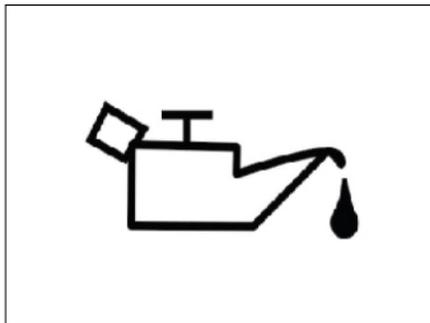
Quando la pressione dell'olio è insufficiente o c'è un guasto al sistema, la spia di allarme pressione olio si accende. In circostanze normali, la spia della pressione dell'olio si accende solo quando l'interruttore di accensione viene ruotato su "ON" e si spegne dopo l'avvio del motore.
