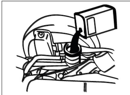
1. Collegare il tubo di ritorno dell'olio all'ingranaggio dello sterzo e riempire con il liquido specifico.
