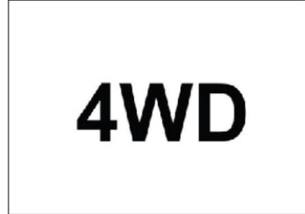
Quando il veicolo si trova nella modalità a quattro ruote motrici ad alta velocità, la spia è accesa.
