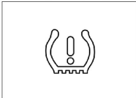
Questa spia si accende quando nello pneumatico si verifica una pressione troppo alta o troppo bassa, una rapida perdita d'aria o una temperatura eccessiva.
