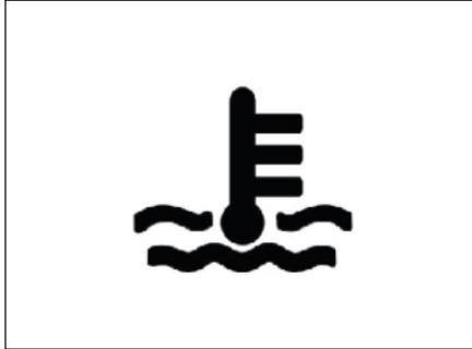
L'accensione della spia della temperatura dell'acqua indica che la temperatura del liquido refrigerante del motore non rientra nei valori normali. Accostare la vettura in sicurezza, spegnere il motore e aprire il cofano, quindi controllare la quantità residua di liquido refrigerante e la puleggia della pompa dell'acqua. In caso di guasti al sistema di raffreddamento, contattare l'assistenza autorizzata EVO ITALIA per farlo controllare.
