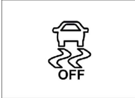
Premere il pulsante dell'interruttore ESC OFF, l'indicatore ESC OFF si accende, indicando che il sistema ESC non è attivo.
