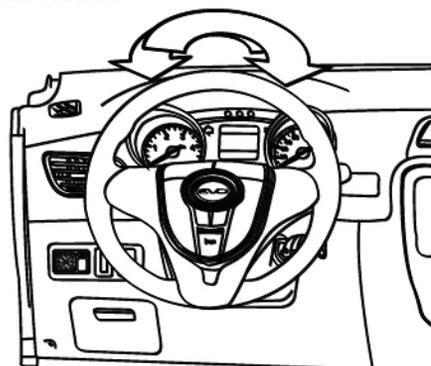
Dalla posizione ACC è necessario premere la chiave affinché la si possa ruotare alla posizione LOCK. Per sbloccare la chiave bloccata, girare semplicemente il volante e girare la chiave.
