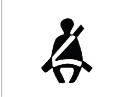
Quando la luce è accesa, significa che la cintura di sicurezza non è allacciata. Quando la chiave di accensione viene girata dalla posizione "OFF" alla posizione "ON" o alla posizione "START", la spia della cintura di sicurezza si accende. Dopo aver avviato il motore, la spia si spegne solo dopo che la cintura di sicurezza è stata allacciata.
