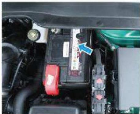
Le etichette di avvertenza per la batteria sono affisse sulla superficie della batteria. La batteria deve essere tenuta lontana da fonti di calore e fiamme libere e deve essere esserne assicurata la ventilazione durante la carica e l'uso per evitare incidenti.
