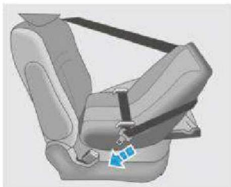
Far passare la cintura di sicurezza a tre punti di ancoraggio attraverso o intorno al seggiolino, inserire la linguetta di bloccaggio nella fibbia di chiusura e assicurarsi che la linguetta e la fibbia siano saldamente bloccate in modo da mantenere la cintura di sicurezza ben tesa.
