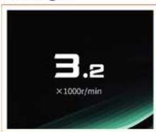
Il contagiri indica il numero di giri del motore al minuto (x1000r/min). Per evitare danni al motore, non guidare a lungo a velocità che rientrano nell'area digitale rossa.
