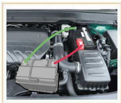
Se il veicolo non può essere avviato a causa dell'insufficiente carica della batteria, può essere utilizzato un cavo di avviamento per avviare il veicolo con l'aiuto delle batterie di altri veicoli. L'uso dell'avviamento di emergenza con cavi è pericoloso e richiede molta cautela
