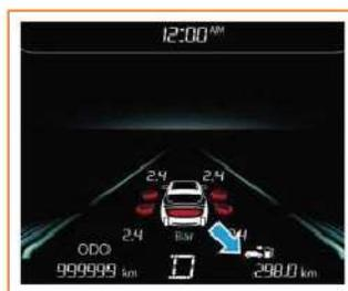
In base al recente consumo complessivo di carburante e alla quantità rimanente nel serbatoio carburante, stima e visualizza la distanza massima che il veicolo attuale può percorrere. L'autonomia di crociera è di 50-999 km. Quando l'autonomia di crociera è inferiore a 50 km viene visualizzato "--".
