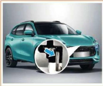
Spostare con il dito la leva di blocco di sicurezza nella parte anteriore del coperchio del vano motore verso sinistra e sollevare il coperchio.
