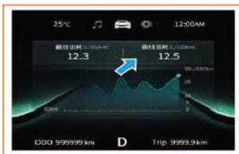
La curva del consumo di carburante mostra l'andamento del consumo di carburante negli ultimi 5 chilometri. Il valore visualizzato corrisponde alla posizione dell'asse delle coordinate del punto più a destra del grafico del consumo di carburante. In base alla richiesta, l'utente può premere brevemente il tasto OK per richiamare l'interfaccia di cancellazione e cancellare separatamente la curva del consumo di carburante.
