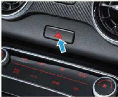
Premere il pulsante delle luci di emergenza sopra il pannello di controllo del condizionatore aria per accendere la spia di delle luci di emergenza. In questa condizione, tutti gli indicatori di direzione all'esterno del veicolo e le spie degli indicatori di direzione e delle luci di emergenza sul quadro strumenti lampeggiano, ricordando ai pedoni e ai veicoli in transito che il veicolo si trova in condizione di avaria.
