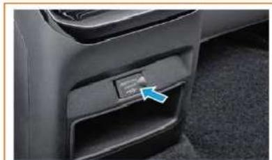
La presa di ricarica USB posteriore si trova sotto la bocchetta di distribuzione aria nella parte posteriore del quadro strumenti ausiliario. La presa funziona solo quando l'interruttore di avviamento è impostato sul "ON" o su "ACC".
