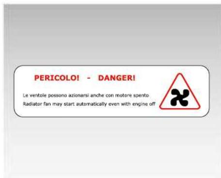
Le etichette di avvertenza per il radiatore e per il refrigerante del condizionatore aria sono affisse all'interno del coperchio del vano motore. È necessario utilizzare il liquido di raffreddamento specificato da il costruttore e non è possibile mescolare marche diverse di liquido di raffreddamento. Non toccare il radiatore in quanto la ventola di raffreddamento può avviarsi in qualsiasi momento.
