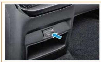
La presa di ricarica USB posteriore si trova sotto la bocchetta di distribuzione aria nella parte posteriore del quadro strumenti secondario. La presa funziona solo quando l'interruttore di avviamento è impostato sul "ON" o su "ACC".
