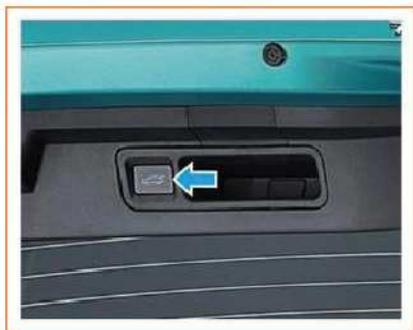
Premendo l'interruttore sulla protezione del portellone vano bagagli si chiude il portellone; se si preme nuovamente l'interruttore durante la chiusura, il portellone arresta il movimento.
