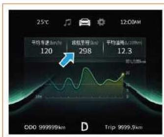
L'autonomia di crociera viene stimata e visualizzata in base all'ultimo consumo complessivo di carburante e alla quantità rimanente nel serbatoio carburante. L'intervallo di visualizzazione dell'autonomia di crociera è 50~999 km. Quando l'autonomia di crociera è inferiore a 50 km viene visualizzato "--".
