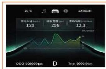
Questa interfaccia visualizza la velocità media, l'autonomia di crociera, il consumo medio e il consumo istantaneo di carburante. La direzione dei tasti al volante su e giù consente di cambiare il contenuto del display.
