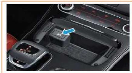
La presa di ricarica USB anteriore si trova nel vano portaoggetti superiore sottopancia. Premere il coperchio del contenitore per aprirlo e utilizzarlo. La presa funziona solo quando l'interruttore di avviamento è impostato sul "ON" o su "ACC".
