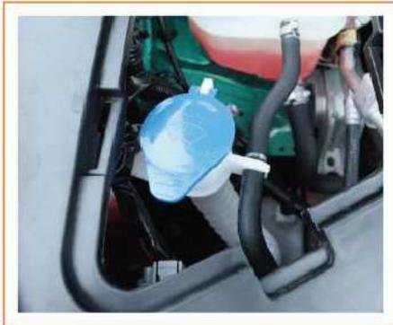
Controllare che il liquido lavavetri contenuto nel serbatoio sia sufficiente.
