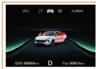
Questa interfaccia visualizza lo stato di funzionamento di porte (compreso il portellone vano bagagli), tetto panoramico, luci e cinture di sicurezza.
