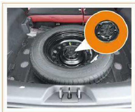
Svitare il bullone centrale di fissaggio della ruota di scorta ed estrarre la ruota di scorta dall'alloggiamento.
