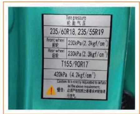
La vettura è dotata di un'etichetta con l'indicazione della pressione degli pneumatici.
