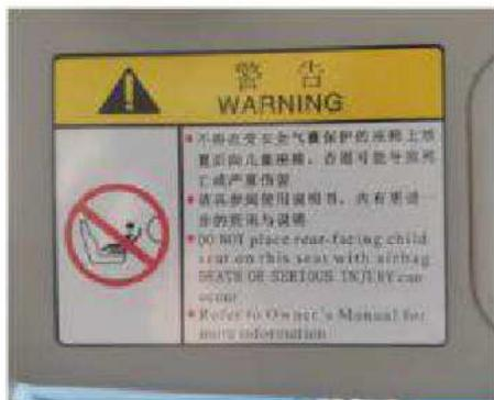
Sull'aletta parasole del passeggero anteriore è presente un segnale di avvertenza dell'airbag. Il seggiolino di sicurezza per bambini rivolto all'indietro non deve essere posizionato sul sedile protetto dall'airbag (in stato attivo), altrimenti, in caso di incidente, l'airbag anteriore dispiegato colpirà il bambino con un forte impatto e causerà gravi lesioni.
