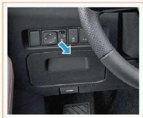
La scatola portafusibili dell'abitacolo si trova nell'angolo inferiore sinistro del lato conducente. Staccare il coperchio per individuare il fusibile.
