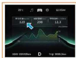
Questa interfaccia visualizza la velocità media del veicolo dopo l'ultimo azzeramento. Intervallo di visualizzazione: 0 ~ 200 km/h.
