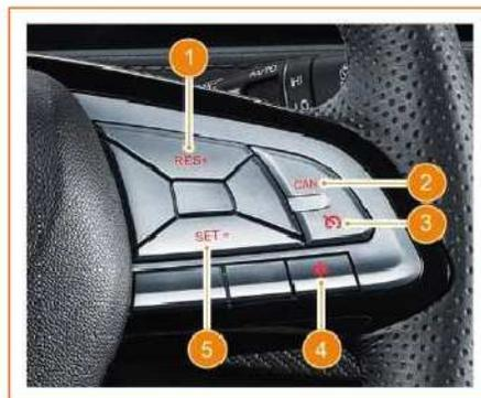
1. Tasto di ripristino/accelerazione della velocità di crociera
