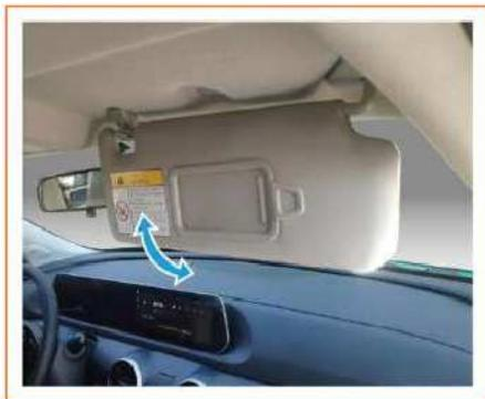
Per evitare condizioni di abbagliamento nella parte anteriore della vettura è sufficiente abbassare l'aletta parasole. Per evitare condizioni di abbagliamento nella parte laterale, rimuovere prima l'asta di supporto destra/sinistra dalla molletta e poi ruotare l'aletta parasole lateralmente.
