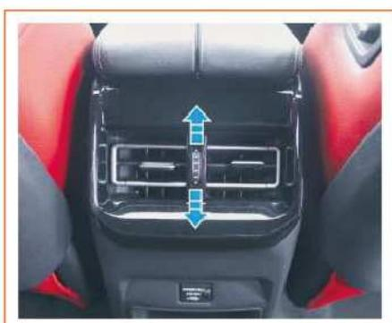
Ruotare la ghiera verso l'alto e verso il basso per aprire e chiudere la bocchetta di distribuzione aria e spostare la griglia al centro della bocchetta verso l'alto e verso il basso, a destra e a sinistra, per cambiare la direzione del flusso d'aria.
