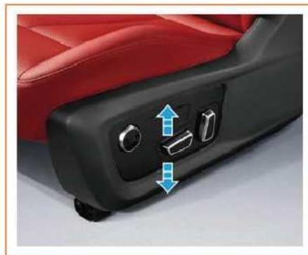
Azionare i pulsanti di regolazione dell'altezza del sedile anteriore e posteriore leggermente verso l'alto o verso il basso per alzare o abbassare il sedile nel suo complesso.
