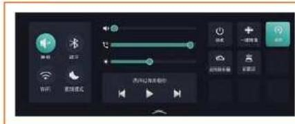
Aprire la schermata del display multimediale e fare clic su "Rearview Mirror Fold" (Ripiegamento dello specchio retrovisore) per ripiegare elettricamente lo specchio retrovisore.
