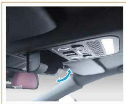
Premendo il coperchio del vano, questo si aprirà lentamente e si richiuderà spingendo il coperchio in posizione.
