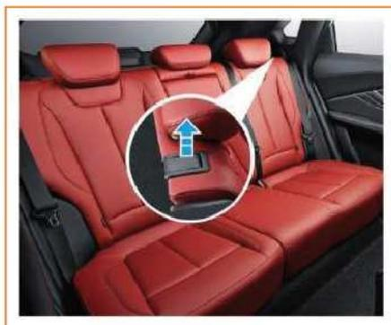
Tirare la fibbia di bloccaggio sulla parte superiore dello schienale per rilasciare il blocco dello schienale, quindi ripiegare delicatamente il sedile in avanti.
