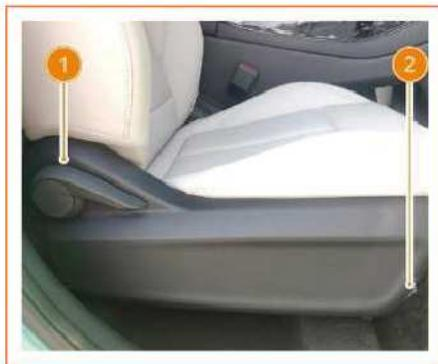
1. Leva di regolazione dell'inclinazione dello schienale
