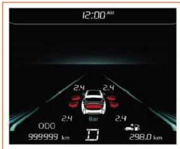
Questa interfaccia visualizza il valore di pressione corrispondente allo pneumatico. Quando la condizione di uno pneumatico è anomala, l'interfaccia del display lo segnala.
