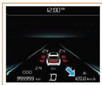
Questa interfaccia visualizza la velocità media del veicolo dopo l'ultimo azzeramento. Intervallo di visualizzazione: 0 ~ 200 km/h. Quando le informazioni di guida indicano la velocità media, premere a lungo il tasto di cambio pagina per azzerare la velocità media.
