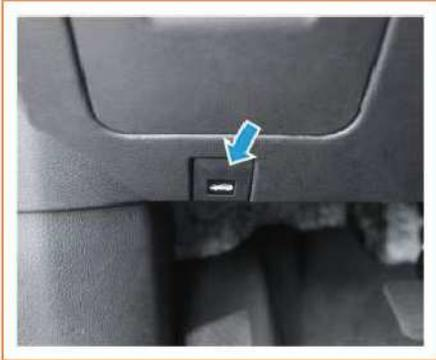
Tirare la maniglia di apertura del coperchio del vano motore situata a sinistra sotto il quadro strumenti per sollevare leggermente e il coperchio del vano motore.
