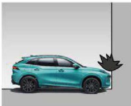
L'airbag anteriore si attiva quando il veicolo si scontra frontalmente con un ostacolo fisso a una velocità di 25 km/h o più.
