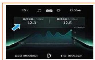
Il consumo ottimale di carburante indica il valore più basso della curva del consumo di carburante dopo l'azzeramento dell'ultimo consumo ottimale.
