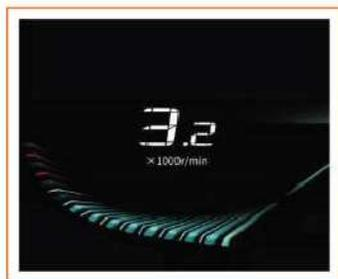
Il contagiri indica il numero di giri del motore al minuto ( $\times 1000\text{r/min}$ ). Sotto il display digitale è presente un'indicazione a barre dinamiche della velocità. Per evitare danni al motore, non guidare a lungo a velocità che rientrano nell'area rossa.
