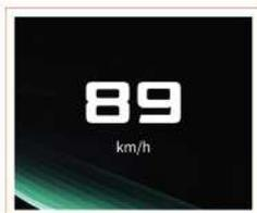
Il tachimetro mostra la velocità corrente (km/h). A causa di fattori quali la pressione degli pneumatici, le condizioni stradali e il clima, la velocità del veicolo visualizzata può discostarsi leggermente da quella effettiva.
