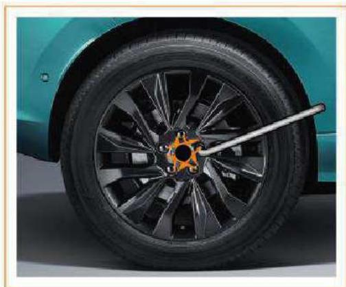
Utilizzare una chiave per dadi ruota per rimuovere il dado ruota, quindi togliere il pneumatico. Rimuovere il fango sulla superficie del mozzo della ruota, quindi installare la ruota di scorta. Serrare i dadi della ruota secondo la sequenza incrociata indicata nella figura
