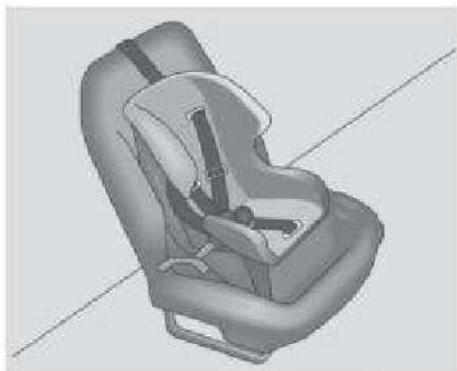
Far passare le cinghie di trattenimento delle gambe e le cinghie di trattenimento delle spalle attraverso o intorno al dispositivo di sicurezza per bambini e inserire la linguetta di bloccaggio nella fibbia di chiusura in modo da mantenere la cintura di sicurezza tesa.
