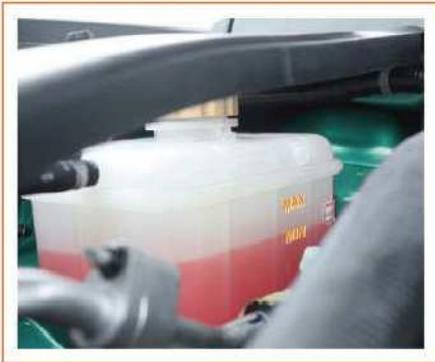
Controllare che il livello del liquido di raffreddamento sia compreso tra il limite superiore (MAX) e il limite inferiore (MIN) della scala graduata. Se è inferiore al contrassegno del livello minimo, aggiungere liquido di raffreddamento nel serbatoio fino a raggiungere il contrassegno del livello massimo.
