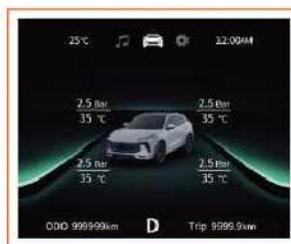
Questa interfaccia visualizza i valori di pressione e temperatura corrispondenti agli pneumatici. Quando la condizione di uno pneumatico è anomala, l'interfaccia del display lo segnala.
