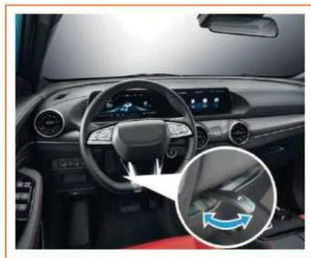
Agendo sulla leva di regolazione presente sul piantone, il volante può essere regolato verso l'alto e verso il basso nella posizione corretta. Dopo la regolazione, assicurarsi che la leva di regolazione sia completamente bloccata.
