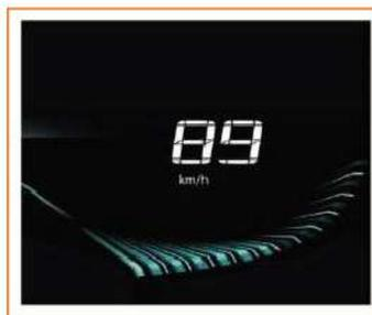
Il tachimetro visualizza la velocità attuale del veicolo (km/h). A causa di fattori quali la pressione degli pneumatici, le condizioni stradali e il clima, possono verificarsi discrepanze tra la velocità del veicolo visualizzata e quella effettiva.
