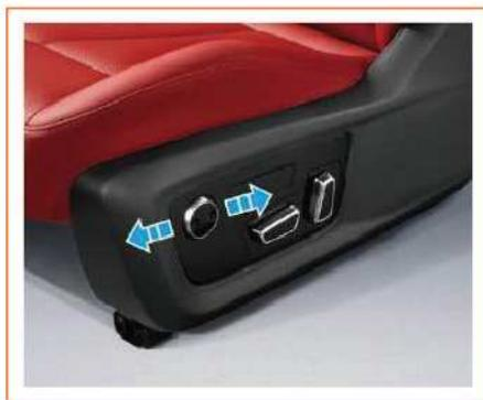
Premere delicatamente i due pulsanti concavi sulla parte anteriore e posteriore dello schienale e il pulsante di regolazione del supporto lombare per aumentare o diminuire il sostegno lombare.
