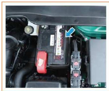
L'accumulatore si trova sul lato sinistro del vano motore e serve principalmente a fornire energia elettrica per l'avviamento del veicolo.
