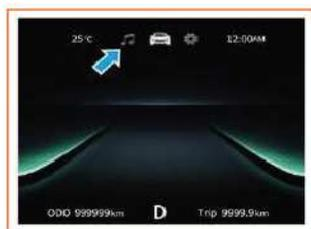
Questa interfaccia visualizza le informazioni di guida, l'assistenza alla guida, il sistema multimediale, la navigazione cartografica e le impostazioni. È possibile cambiare il contenuto del display tramite i tasti al volante destro e sinistro.
