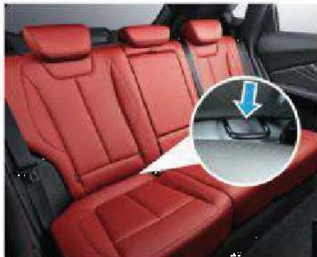
Oltre all'uso di cinture di sicurezza a tre punti di ancoraggio per proteggere i bambini, i sedili posteriori dispongono anche un sistema di sicurezza per bambini con interfaccia ISOFIX. I dispositivi di sicurezza per bambini conformi alle norme ISO sono fissati dall'interfaccia ISOFIX e non è necessaria alcuna sicurezza aggiuntiva.
