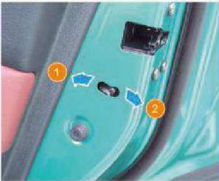
Le serrature delle porte posteriori per la sicurezza dei bambini aiutano a prevenire l'apertura accidentale delle porte posteriori, soprattutto in presenza di bambini a bordo. Quando la leva è in posizione di blocco 1, la serratura della porta posteriore di sicurezza per bambini è attivata e la porta posteriore può essere aperta solo dall'esterno. Per sbloccare la serratura della porta posteriore di sicurezza per bambini, spostare la leva in posizione di sblocco 2.
