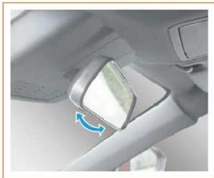
Tirando delicatamente la linguetta sul bordo inferiore dello specchio retrovisore, si cambia lo stato di riflessione della lente per evitare condizioni di abbagliamento.
