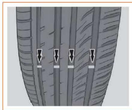
Lo pneumatico deve essere mantenuto in buone condizioni e le sculture del battistrada devono avere una profondità sufficiente. È possibile utilizzare gli appositi punti in rilievo per misurare il grado di usura del pneumatico. Se lo spessore del battistrada è 1,6 mm, lo pneumatico deve essere sostituito. Uno pneumatico in queste condizioni manca di aderenza quando si guida su strade bagnate e scivolose.
