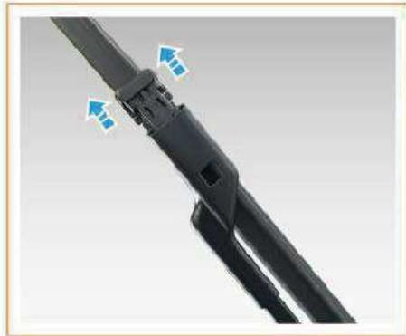
2. Sostituire con una nuova spazzola tergicristallo e procedere in senso inverso per assicurarsi che la spazzola sia installata correttamente in posizione.
