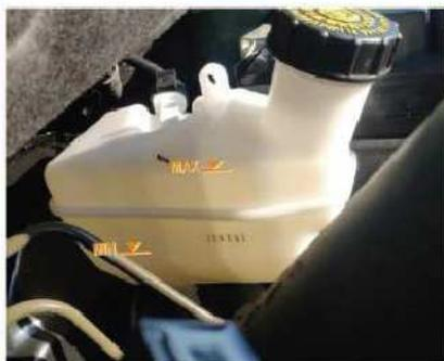
Il livello del liquido nel serbatoio deve essere controllato una volta al mese. Verificare che il livello del liquido dei freni sia compreso tra i contrassegni dei limiti superiore (MAX) e inferiore (MIN). Se il livello del liquido è pari al limite inferiore (MIN), o al di sotto di esso, è necessario verificare l'eventuale presenza di perdite dell'impianto frenante.
