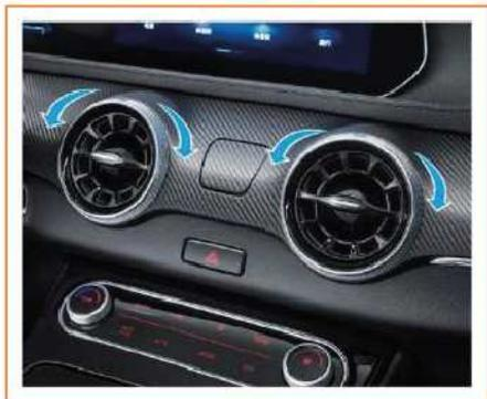
Ruotare la manopola della bocchette di distribuzione aria in senso orario per chiudere la bocchetta e in senso antiorario per aprirla. La direzione del flusso dell'aria può essere modificata spostando la griglia al centro della bocchetta di distribuzione aria verso l'alto e verso il basso, a destra e a sinistra.
