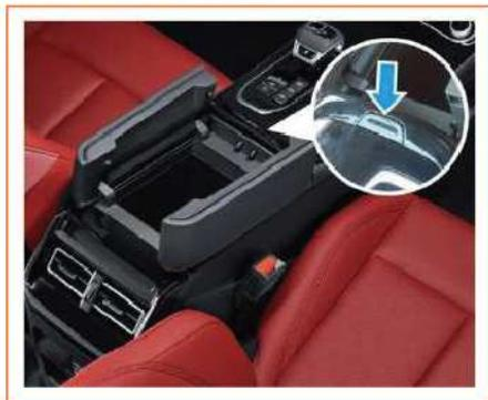
Sotto il bracciolo centrale anteriore è stato previsto un vano portaoggetti centrale. Premendo il pulsante sulla parte anteriore del bracciolo centrale, il vano portaoggetti centrale si aprirà automaticamente.
