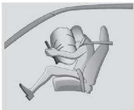
Quando il veicolo subisce un forte impatto, il modulo di comando dell'airbag monitora la decelerazione causata dall'urto e provoca il dispiegamento dell'airbag. Se la condizione di attivazione dell'airbag è soddisfatta, l'airbag si dispiega rapidamente e, insieme alla cintura di sicurezza, fornisce una protezione aggiuntiva per la testa e il torace di guidatori e passeggeri allo scopo di ridurre le lesioni.
