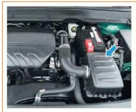
L'elemento del filtro dell'aria deve essere sostituito in base al tempo e al chilometraggio indicati nella tabella di manutenzione periodica. Se il filtro dell'aria non è installato correttamente, può facilmente penetrare la polvere presente nell'aria, causando un'usura anomala del cilindro. Se è necessario sostituire l'elemento filtrante, contattare il servizio di assistenza speciale del produttore.
