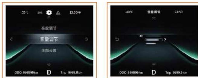
Questa interfaccia può regolare il volume del quadro strumenti. Premere i tasti su e giù del volante per aumentare e diminuire il volume rispettivamente, e premere il tasto sinistro per uscire dall'interfaccia di regolazione del volume.
