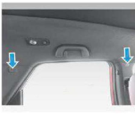
L'airbag a tendina laterale è installato sopra le porte destra e sinistra della vettura ed è contrassegnato dalla scritta "SRS AIRBAG". In caso di collisione laterale moderata o grave, l'airbag a tendina si attiva per proteggere la testa del guidatore e degli altri passeggeri dall'impatto con la parete interna del veicolo.
