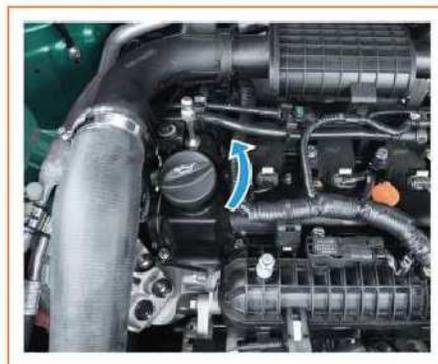
1. Svitare il tappo di riempimento dell'olio motore e riempire con olio motore.
