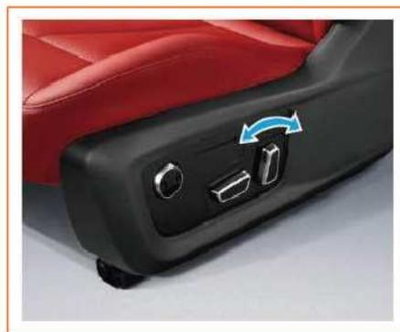
Spingere delicatamente la parte superiore del pulsante di regolazione dell'inclinazione dello schienale in avanti o indietro per regolare l'inclinazione dello schienale in avanti o indietro.
