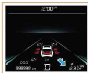
Questa interfaccia visualizza il consumo medio di carburante dopo l'ultimo azzeramento. Intervallo di visualizzazione: 0~19.9L/100 km. In base alla richiesta, il consumo medio di carburante può essere azzerato separatamente premendo a lungo il tasto di cambio pagina.
