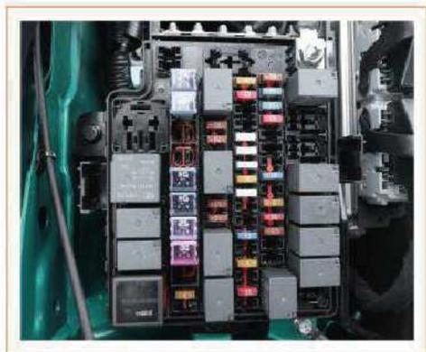
La scatola dei fusibili del vano motore si trova sul lato anteriore sinistro del vano motore. Sganciare le fibbie sui lati destro e sinistro della scatola dei fusibili e aprire il coperchio della scatola per controllare il fusibile.
